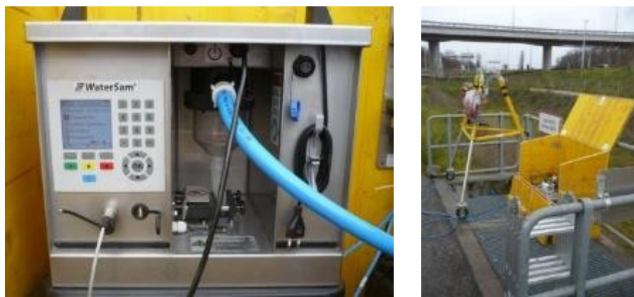
Abbildung 9: Einrichtung Ablauf AFS Probenehmer Sterngasse (Quelle: B. Monai).
